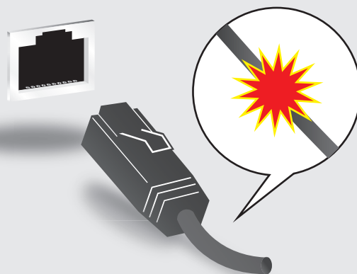
(B) LANケーブルが正常ではない (接触不良・断線など)
